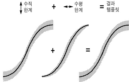
소스 파형과 엔벨로프 파형의 비교는, 각 소스 파형 샘플 포인트 값과 해당 엔벨로프 파형 샘플 포인트의 수직 및 수평 최소/최대값과의 비교값입니다. 대응하는 템플릿 엔벨로프 최소/최대값과 같지 않거나 그 값 내에 포함되지 않는 소스 파형 데이터 포인트는 위반입니다.
