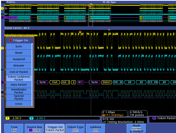
Figure 1. USB Full Speed 직렬 버스에서의 특정 OUT 토큰 패킷 트리거링. 노란색 파형은 D+이며 파란색 파형은 D-입니다. 버스 파형은 시작, 동기, PID, 주소, 엔드 포인트, CRC, 데이터 값, 정지를 포함하여 디코딩된 패킷 콘텐츠를 제공합니다.
