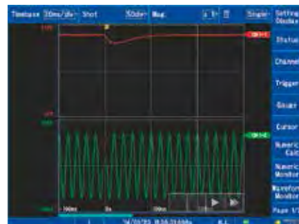
MR8901 표준 아날로그 유닛 MR8901에 차동 프로브 P9000을 사용하면 CAT III 1000V의 고전압 측정이 가능해집니다. 또한 P9000-02는 교류전원라인의 실효값 레벨도 측정할 수 있습니다.
