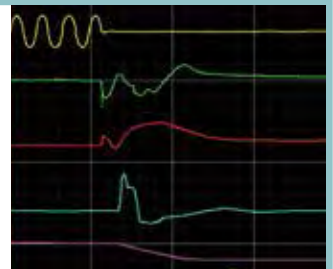
● 부하 차단 시험에 차단 전후의 발전기의 전압, 회전수의 변동률, governor servo 동작상황, 제압기의 개폐 타이밍 등의 상관관계를 해석
