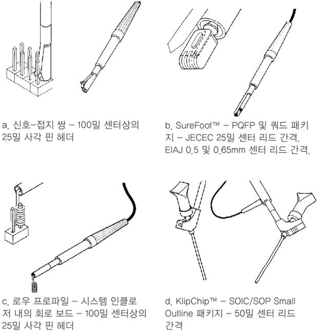
그림 2.16. 소형 지오메트리 프로브용 프로브 팁 어댑터의 몇 가지 예, 이러한 어댑터를 사용하면 소형 회로를 훨씬 쉽게 프로빙할 수 있으며, 무결성 높은 프로브 대 테스트 지점 연결을 제공함으로써 측정 정밀도도 높일 수 있습니다.
