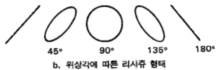
그림 2-11. 리사쥬 도형법에 의한 위상 측정
