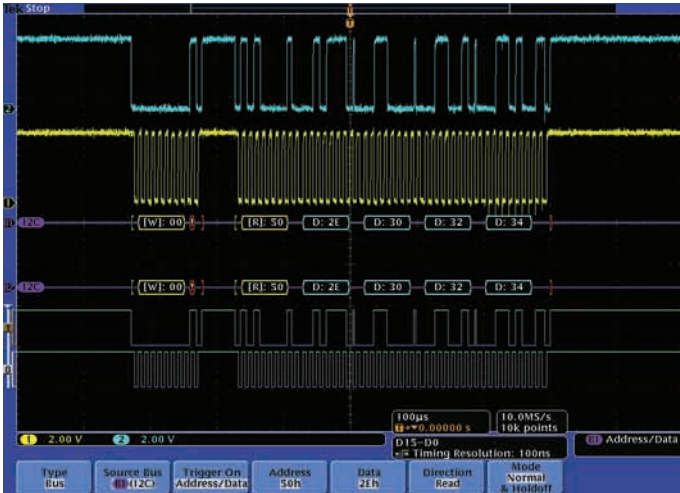
Figure 1. I 2 C 버스를 통과하는 특정 데이터 패킷을 대상으로 트리거. 노란색 파형은 클럭이며 파란색 파형은 데이터입니다. 버스 파형은 시작, 주소, Read/Write, 데이터 및 정지를 포함하여 디코딩된 패킷 콘텐츠를 제공합니다.
