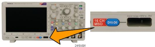
4. D15~D0 On/Off 하단 베젤 버튼을 누른 다음 D7~D0 켜기 사이드 베젤을 눌러 디지털 파형을 표시합니다. 채널을 끄려면 범용 노브 a를 사용하여 채널을 선택하고 "디스플레이" 사이드 베젤을 눌러 Off를 선택합니다.
