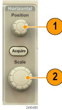
트리거 이전에 발생하는 레코드의 일부를 사전 트리거 부분이라고 합니다. 이 부분은 트리거가 사후 트리거 부분이 되기 전에 발생합니다. 사전 트리거 데이터는 문제 해결에 도움을 줄 수 있습니다. 예를 들어, 테스트 회로에서 원치 않는 글리치의 원인을 찾으려는 경우 글리치에서 트리거하고 글리치 전에 데이터를 포착할 수 있을 만큼 사전 트리거 주기를 크게 할 수 있습니다. 글리치 전에 어떤 상황이 발생하는지 분석하면 글리치의 원인을 찾아내는 데 도움이 되는 정보를 얻을 수 있습니다. 또는 트리거 이벤트로 인해 시스템에서 일어나는 상황을 확인하기 위해 사후 트리거 기간을 트리거 이후의 데이터를 캡처할 수 있을 만큼 길게 설정하십시오.
