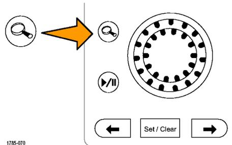
3. 파형의 줌된 보기가 디스플레이의 확대된 하단 부분에 나타나는지 살펴 봅니다. 디스플레이의 상단 부분에는 전체 레코드 컨텍스트 내에 파형의 줌된 부분의 위치 및 크기가 표시됩니다.
