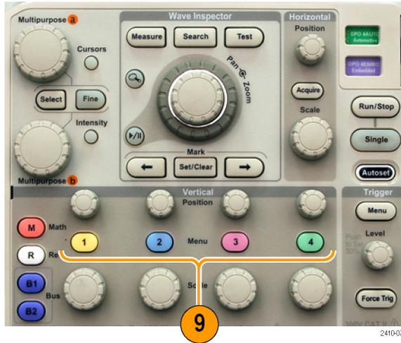
10. **B1** 또는 **B2**. 올바른 모듈 애플리케이션 키가 있는 경우 버스를 정의하고 표시하려면 이 버튼을 누릅니다. DPO3AUTO 모듈은 CAN 및 LIN 버스를 지원합니다. DPO3EMBD 모듈은 I<sup>2</sup>C 및 SPI를 지원합니다. DPO3COMP 모듈은 RS-232, RS-422, RS-485 및 UART 버스를 지원합니다. DPO3AUDIO 모듈은 I<sup>2</sup>S, LJ(왼쪽 정렬), RJ(오른쪽 정렬) 및 TDM 버스를 지원합니다.
