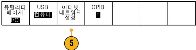
6. 사이드 베젤 메뉴에서 DHCP 이더넷 네트워크가 표시되며 동적 주소 지정을 사용하는 경우 DHCP를 "On"으로 설정합니다. 정적 주소 지정을 사용하는 경우에는 DHCP를 "Off"로 설정합니다.
