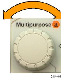
4. 측정치를 제거하려면 "측정치 제거"를 누르고, 범용 노브 a를 돌려 특정 측정을 선택하고, 사이드 베젤 메뉴의 "OK 측정치 제거"를 누릅니다.
