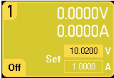
Voltage 및 Current 노브를 돌립니다. 노브를 돌리면 출력 전압 또는 전류 설정이 변경됩니다. 활성화되는 경우 출력 또한 변경됩니다. 이 노브는 Meter View, Scope View, Data Logger 모드에서 작동합니다.
