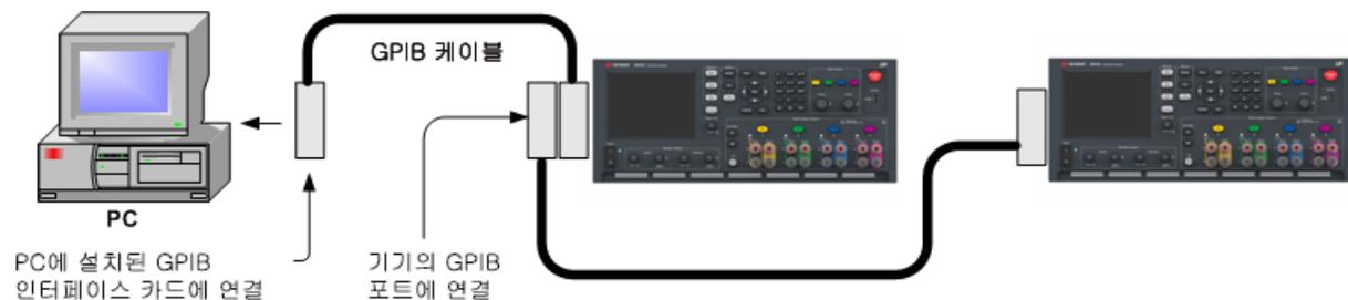
1. 컴퓨터에 GPIB 인터페이스 카드가 설치되어 있지 않다면 컴퓨터를 끄고 GPIB 카드를 설치합니다.
