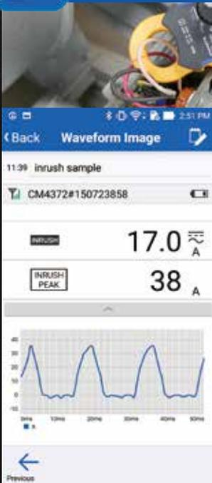
측정한 값이 이상하다고 생각될 때는 간단 오실로스코프 기능이 편리합니다. 샘플링 주파수는 1.44 kHz ~ 28.8 kHz 이며 자동 가변됩니다 . ※ 1
