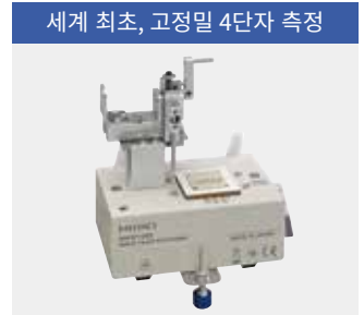
SMD 테스트 픽스처 IM9100 바닥면에 전극이 있는 SMD 용 측정 가능 시료 크기 : 0402~1005 (JIS 단위 mm) 측정 본체에 직결 타입
