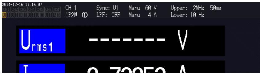
표시 항목으로 **OFF** 가 선택된 경우나 선택된 항목이 설정에 의해 무효가 된 경우는 수치 표시 부분이 공백이 됩니다.
