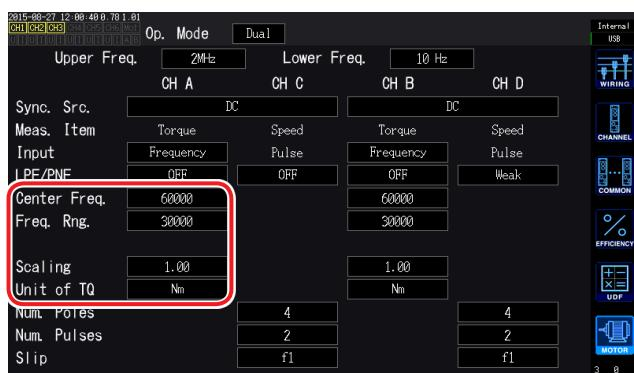
**Input**을 **Frequency**로 설정한 경우는 센서에 맞춰 **Center Freq.**, **Freq. Rng.**, **Scaling**, **Unit of TQ**의 4개 항목을 설정합니다.
