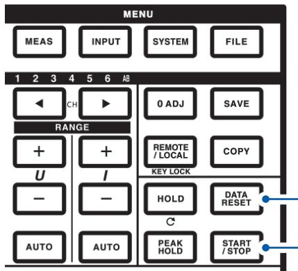
적산이 정지 상태(**[START/STOP]** 키가 적색으로 점등)인 경우에 **[DATA RESET]** 키를 누르면 적산값이 리셋됩니다.
