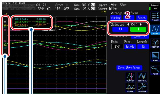
변경 중인 항목의 div 표시 레인지와 표시 위치가 표시됩니다.
