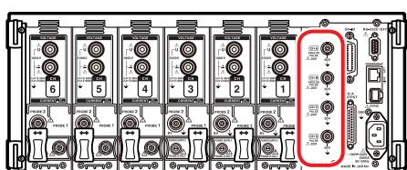
모터 & D/A 내장 모델에서는 본 기기 뒷면에 CH A, CH B, CH C, CH D의 4가지 입력 단자(절연형 BNC 커넥터)가 있습니다.
