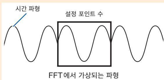
FFT의 연산 포인트 수가 측정 파형 주기와 일치하지 않는 경우는 원도우 내 파형의 양 가장자리가 불연속이 되어 leakage 오차라고 불리는 오차가 발생하며, 실제로는 존재하지 않는 FFT 분석 결과가 검출됩니다.
