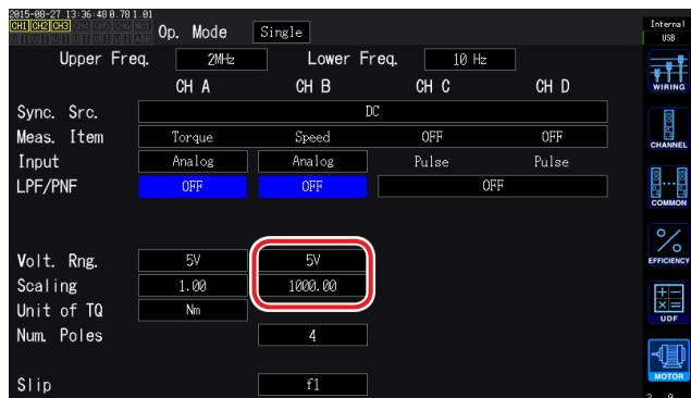
Input을 Analog로 설정한 경우는 회전 신호에 맞춰 Volt. Rng., Scaling의 2개 항목을 설정합니다.
