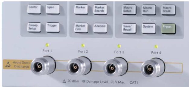
ENA 시리즈의 내장된 2~4개의 테스트 포트
