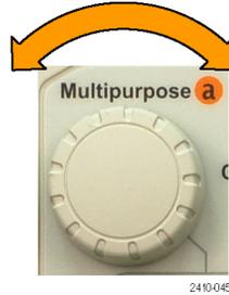
4. 측정치를 제거하려면 측정치 제거를 누르고, 범용 노브 a를 돌려 특정 측정을 선택하고, 사이드 베젤 메뉴의 측정치 제거 확인을 누릅니다.
