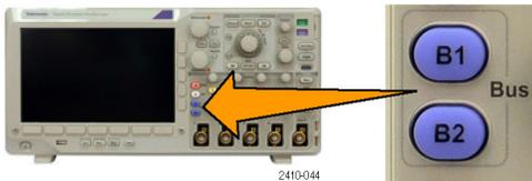
6. 버스 표시 하단 베젤 버튼을 누르고 버스 및 파형 사이드 베젤 버튼을 누른 다음 ASCII 사이드 베젤을 누릅니다.
