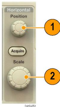
트리거 이전에 발생하는 레코드의 일부를 사전 트리거 부분이라고 합니다. 이 부분은 트리거가 사후 트리거 부분이 되기 전에 발생합니다. 사전 트리거 데이터는 문제 해결에 도움을 줄 수 있습니다. 예를 들어, 테스트 회로에서 원치 않는 글리치의 원인을 찾으려는 경우 글리치에서 트리거하고 글리치 전에 데이터를 포착할 수 있을 만큼 사전 트리거 주기를 크게 할 수 있습니다. 글리치 전에 어떤 상황이 발생하는지 분석하면 글리치의 원인을 찾아내는 데 도움이 되는 정보를 얻을 수 있습니다. 또는 트리거 이벤트로 인해 시스템에서 일어나는 상황을 확인하기 위해 사후 트리거 기간을 트리거 이후의 데이터를 캡처할 수 있을 만큼 길게 설정하십시오.
