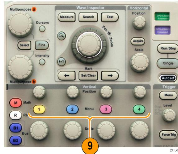
10. B1 또는 B2. 올바른 모듈 애플리케이션 키가 있는 경우 버스를 정의하고 표시하려면 이 버튼을 누릅니다. DPO3AUTO 모듈은 CAN 및 LIN 버스를 지원하고, DPO3EMBD 모듈은 I<sup>2</sup>C 및 SPI를 지원하며, DPO3COMP 모듈은 RS-232, RS-422, RS-485 및 UART 버스를 지원합니다.
