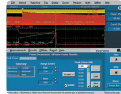
▶ TDSPWR3 전력 측정 및 분석 소프트웨어를 사용하면 Tektronix 디지털 오실로스코프를 전력 공급 스위칭 장치 및 자기 구성 요소의 전력 방출을 신속하게 측정하고 분석하는 정교한 분석 도구로 바꾸어 주며 사용자가 지정된 형식으로 상세한 테스트 보고서를 생성할 수 있습니다.
