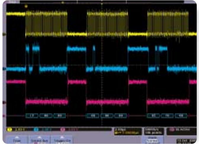
▶ 그림 12. SPI 버스의 합성기 구성 메시지 획득
