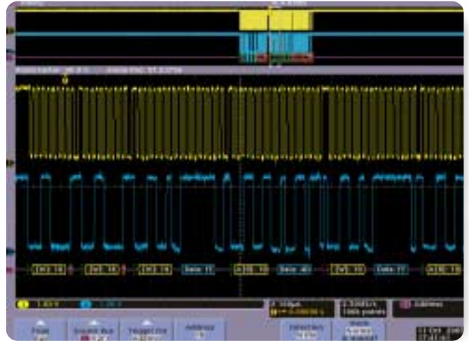
▶ 그림 7. I 2 C 주소 및 데이터 버스 파형 디코딩
