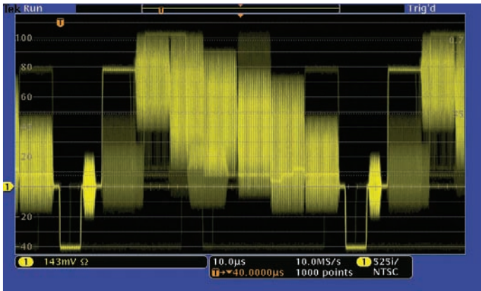
NTSC 비디오 신호 확인. DPO에서 제공하는 명암 그레이딩 보기 기능은 시간, 진폭, 시간 경과에 따른 진폭의 분포를 재현합니다.
